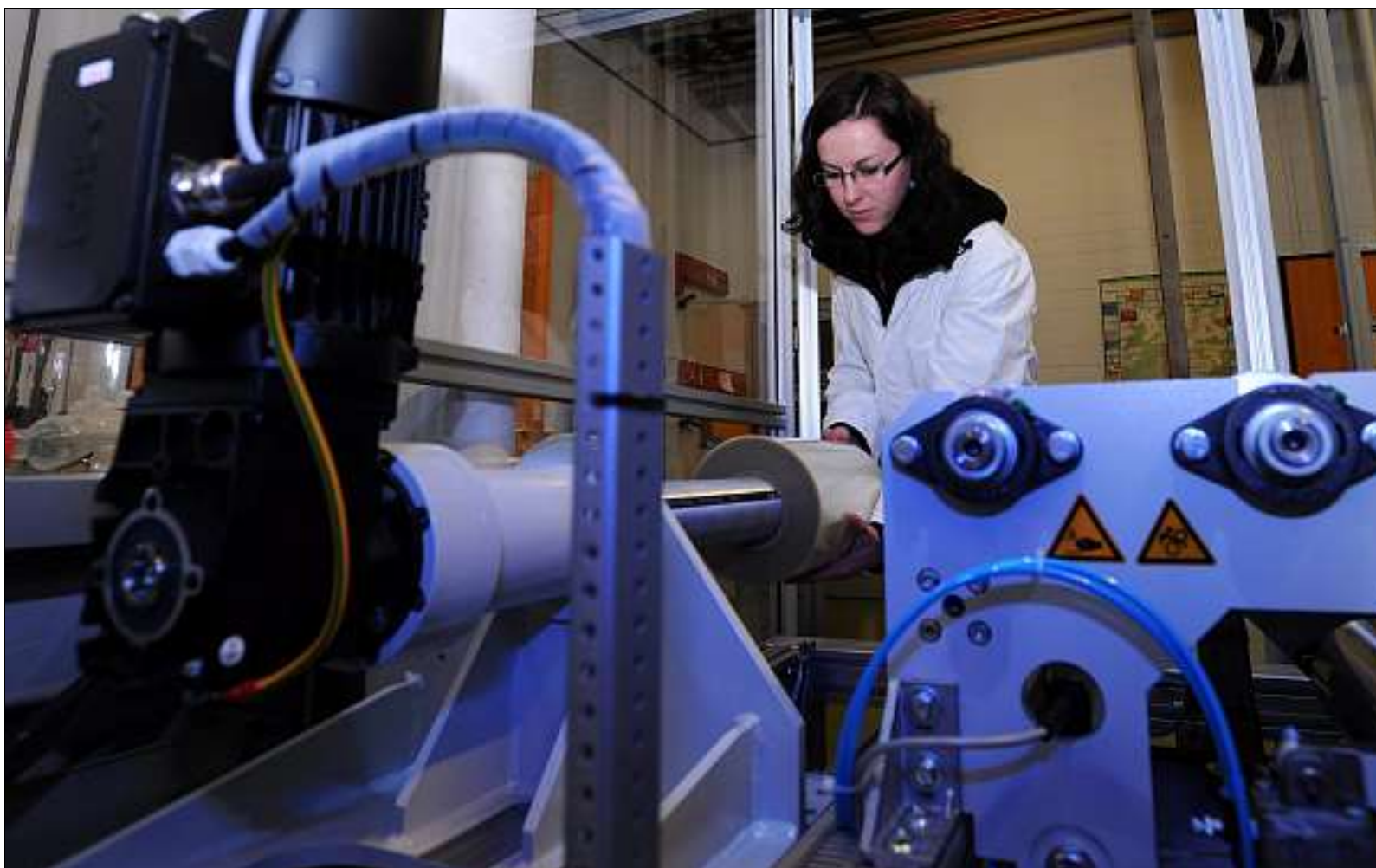
Carmen Marschner bestückt eine Sol-Gel-Anlage im Technikum der Innovent-Technologieentwicklung in Jena. Mit der Anlage des Institutes lassen sich Kunststofffolien mit einer Spezialfunktion versehen, die zum Schutz von Kulturgütern zum Einsatz kommen könnten. Foto: Tino Zippel
