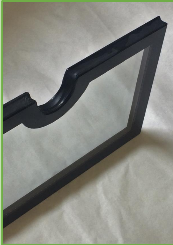
Typisches verwendetes Isolierglas mit Randausschnitt
