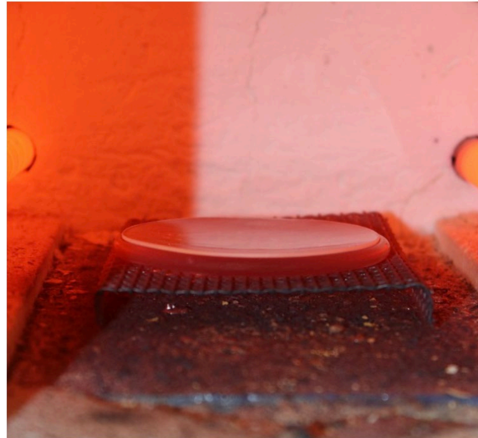
Abb. 180 Blick in den Ofen: bereits abgesenktes Glas
