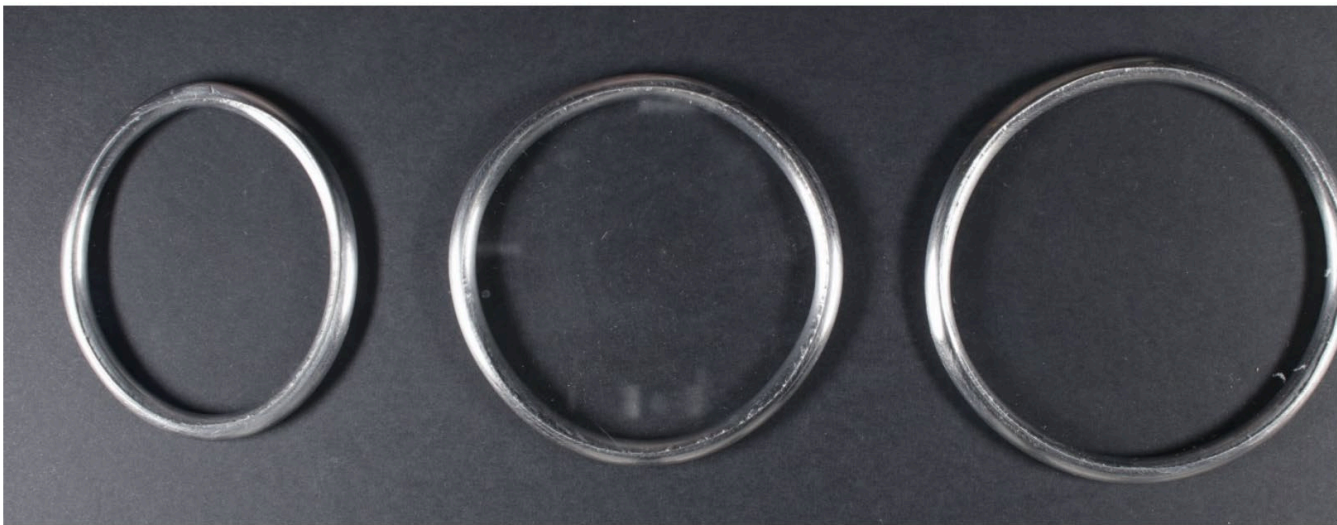
Abb. 178 Senkbiegen: Formen aus 5 mm Stahldraht
