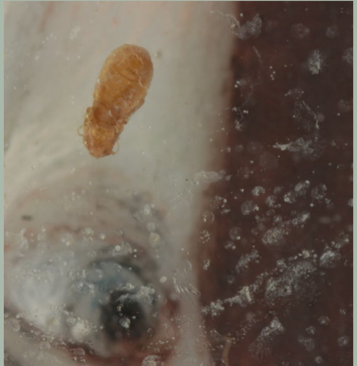
Alkalische Tröpfchen und Kristalle auf den Innenseiten der Deckgläser (Inv. Nr. 1457, Inv. Nr. 4835, Inv. Nr. M.L.721)
