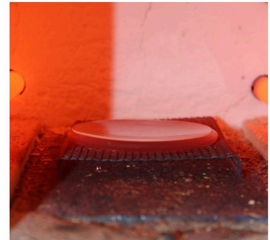
Abb. 180 Blick in den Ofen: bereits abgesenktes Glas
