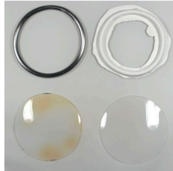
Abb. 185 Visueller Unterschied nach dem Senkbiegen mit Metall- und Gipsformen
